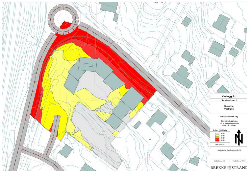
Høyeste prognosert støynivå fra veg 2039 målt 1,5 meter over terreng. Figuren viser hvordan orienteringen av bebyggelsen skaper en innside med dempet støy. Figur Brekke og Strand AS
